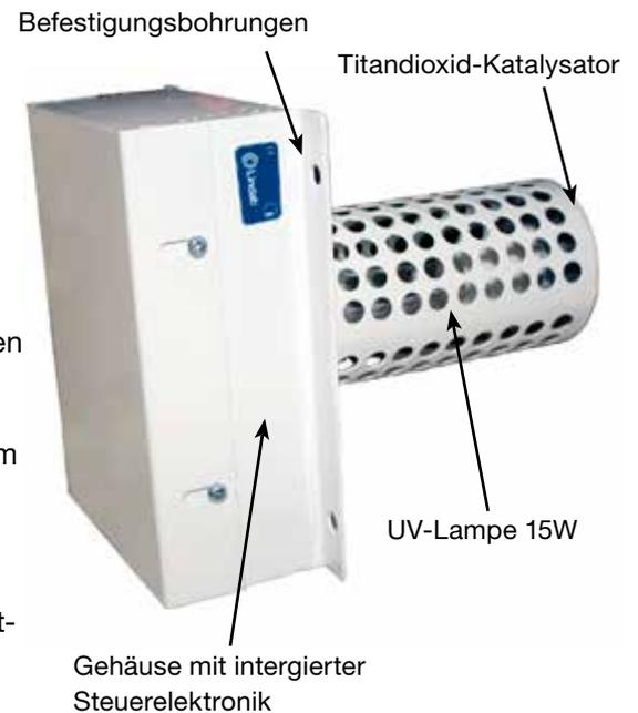
HINWEIS: Die Einheit erfordert keine spezielle Wartung. Beachten Sie, dass die Lampe eine Bestrahlungslebensdauer von 8.000 bis 10.000 Stunden hat.
